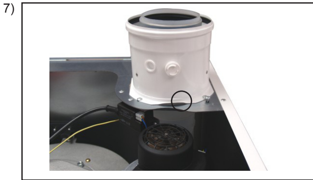
Μετά το βγάλσιμο του πάνω καπακιού του καλύμματος, ξεβιδώστε την βίδα κλειδώματος του αεραγωγού/καπναγωγού.
